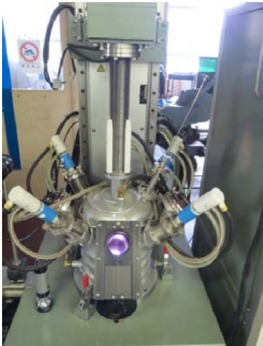
写真4 テトラアーク式引上装置(外観)
