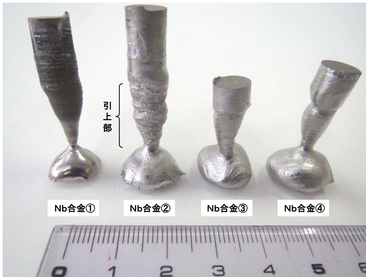
写真1 テトラーク式引上装置を用いて作製した合金試料
