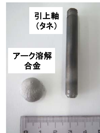
写真2 アーク溶解合金と引上軸
