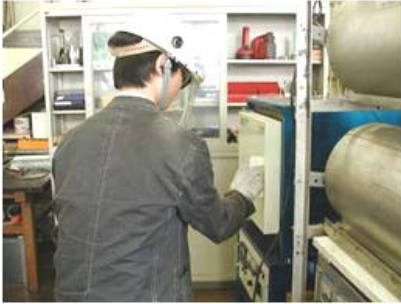
■ 真空熱処理炉による熱処理実験
