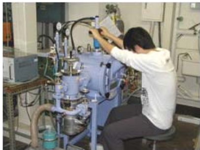
■アーク溶解炉による試料溶解
